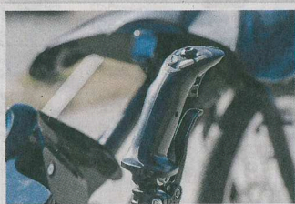
JOYSTICK Issu d'un kit de jeu vidéo, il suffit de le pencher à gauche ou à droite pour tourner. LOUIS DASSELBORNE
